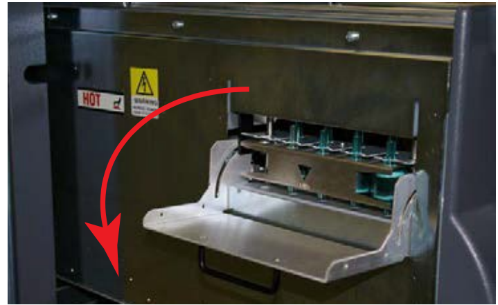
Pyrolyzer Filter Door
