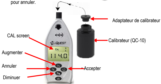
Figure 1-10 : Étalonnage du SD-200
