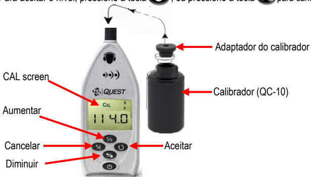
Figura 1-10: Calibração do SD-200
