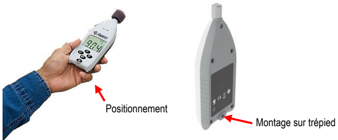
Figure 1-9 : Positionnement et montage sur trépied
