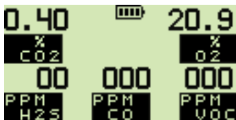
Fig. 3.7 CO2 Sensor - Zero Fault
