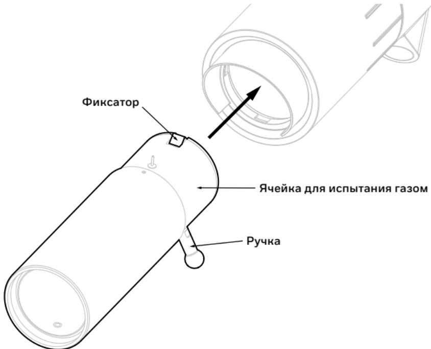
2. Поверните ручку по часовой стрелке, чтобы зафиксировать для фиксации ячейку для испытания газом на приемнике.
