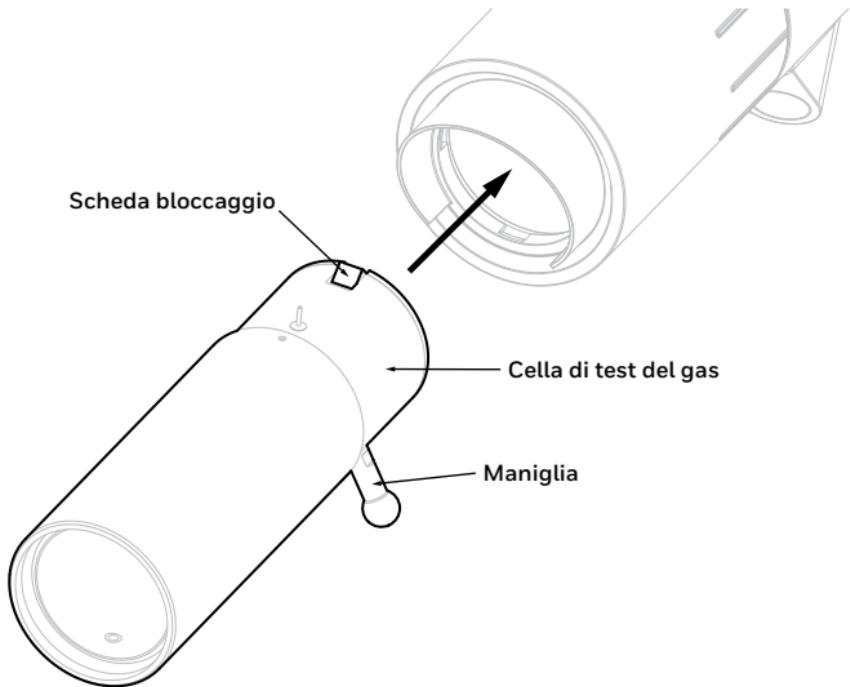
2. Ruotare la maniglia in senso orario per bloccare la cella di test di gassificazione sul ricevitore.
