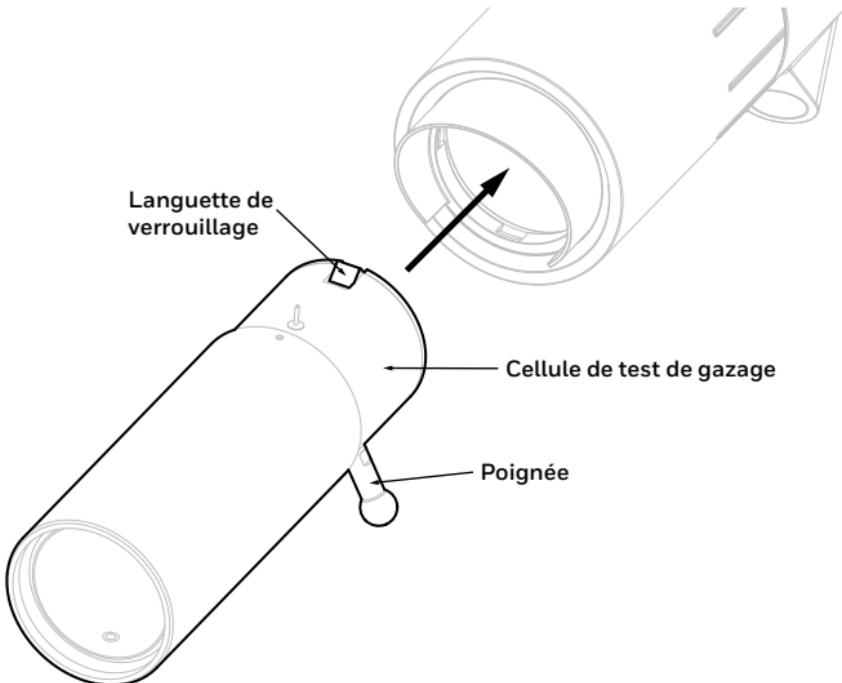
2. Faites pivoter la poignée dans le sens des aiguilles d'une montre pour verrouiller la cellule de test de gazage sur le récepteur.
