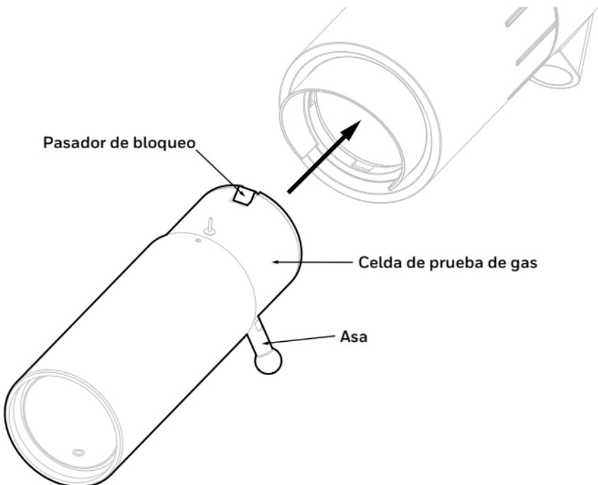
2. Gire el asa en sentido horario para bloquear la celda de prueba de gas en el receptor.
