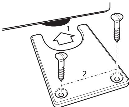
S'assurer que l'appareil est positionné correctement. Depuis les côtés de l'appareil, faire glisser les supports de pieds autour de chacun des pieds arrière (1). Les fixer en place à l'aide des deux vis n° 8 x 20 mm (2).
