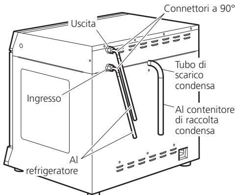
Attaccare i due connettori a 90° ai due connettori situati nella parte posteriore dell'unità e contrassegnati INLET (INGRESSO) e OUTLET (USCITA). Collegare il tubo in EPDM con diametro interno (ID) di 8 mm e lungo 1,5 m ai connettori e fissare saldamente con le fascette stringitubo. Collegare le altre estremità dei connettori alle porte dell'unità di raffreddamento assicurandosi che il tubo non presenti strozzature; non serrare eccessivamente.
