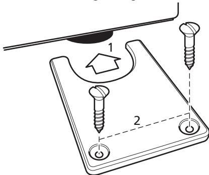
Vergewissern Sie sich, dass das Gerät richtig aufgestellt ist. Schieben Sie die Fixierungen jeweils von der Seite des Geräts um einen der hinteren Standfüße (1). Befestigen Sie die Fixierung mit 2 Schrauben (8 x 20 mm) (2).
