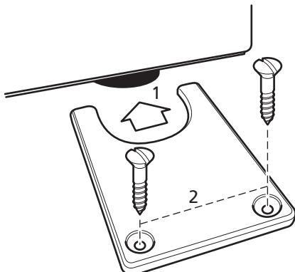
Asegúrese de que la unidad esté colocada correctamente. Desde los laterales de la unidad, deslice las abrazaderas en torno a cada una de las patas traseras (1). Fíjelas en su lugar con dos tornillos nº 8 de 20 mm (2).
