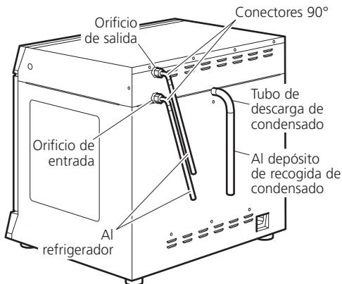
Se obtendrá un rendimiento óptimo con el tubo de conexión lo más corto posible. Tenga en cuenta las especificaciones del refrigerador para las longitudes aceptables de los tubos y la altura máxima del cabezal. Coloque el refrigerador en una posición segura para evitar una colisión accidental.
