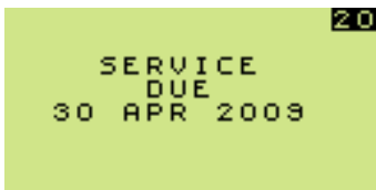
Fig. 3-18 Service Due Date
